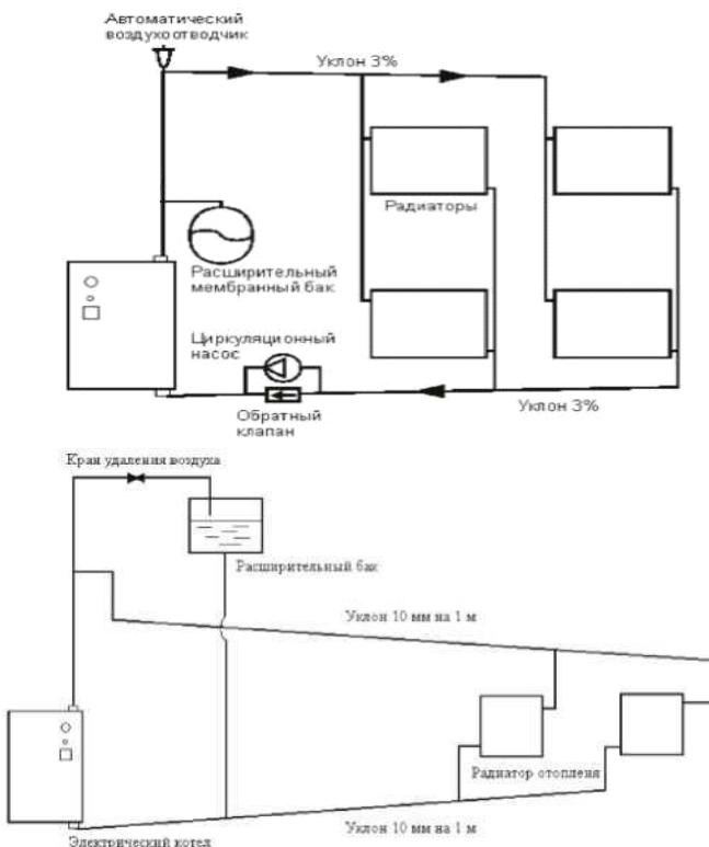
Для лучшей циркуляции воды при использовании электрического котла в открытой системе отопления желательно установить в систему циркуляционный насос.
